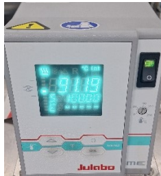
100°C設定稼働 表示温度: 91.2°C
