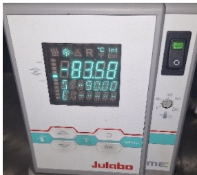
-90°C設定稼働 表示温度: 83.5°C
